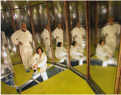
Abbildung 4: Peter Braun Munzinger und Johanna Stachel beim Bau der TPC (Time Projection Chamber) für das ALICE Experiment am CERN LHC. (Foto: Michael Hoch)
