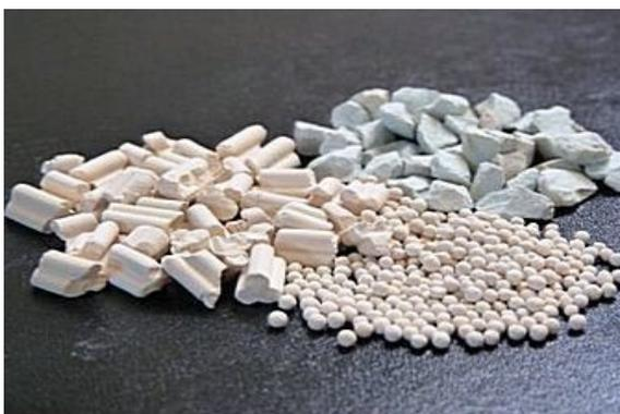
**Abbildung 4:** Drei Zeolithqualitäten: Zur Abluftreinigung (links), als Trockenmittel (rechts) und Klinoptilolith ("Naturzeolith")
