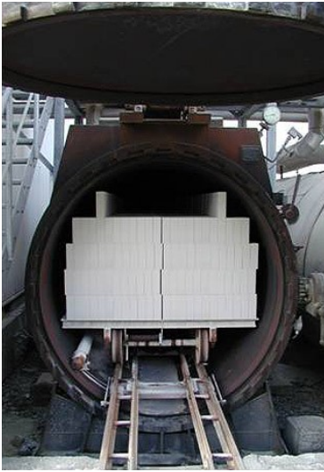
Abbildung 3: Gebrauchsfertige Kalksandsteine im Autoklaven nach der Dampferhärtung
