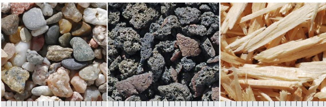
Abbildung 1: Gesteinskörnungen und Zuschläge für Beton (v.l.n.r.: Rheinkies, Blähton, Holzspäne)
