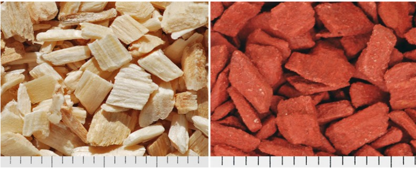
Abbildung 2: Würfelförmige Holzspäne (links: unbehandeltes Material; rechts: mineralisch ummantelte Holzspäne)
