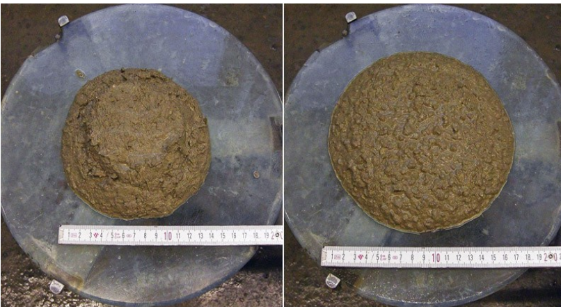
Abbildung 4: Ausbreitmaß von Beton mit länglichen Spanen (links) und würfelförmigen Spanen (rechts)
