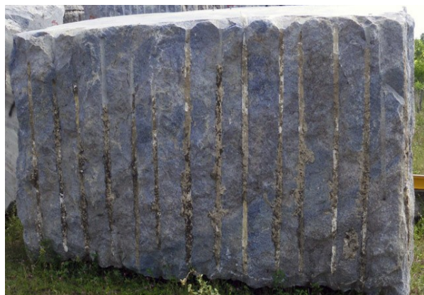
Abbildung 5: Block aus blauem Sodalithgestein mit Resten des verwendeten Sprengmörtels in den Bohrlöchern
