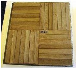
Probekörper nach Wasserlagerung – Parkettstäbe wurden mit elastischem Klebstoff verklebt
