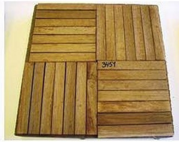
Probekörper nach Wasserlagerung – Parkettstäbe wurden mit hartem Dispersionsklebstoff verklebt
