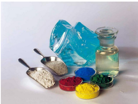
Abbildung 9: Grundbestandteile von Silikatfarben: Wasserglas, Pigmente, Füllstoffe [10]
