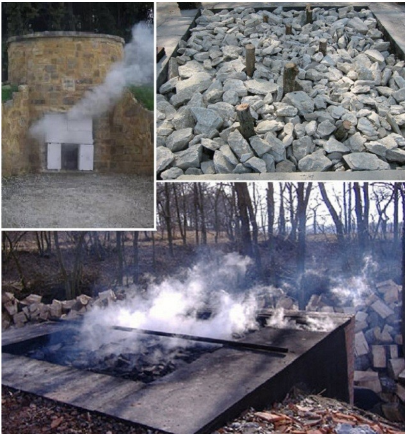
Abbildungen 6-8: oben links: Nachbau eines Feldbrandofens oben rechts: Befüllen des Feldbrandofens unten: Gipsbrand
