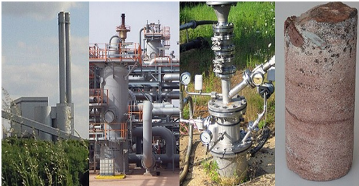
Abbildung 4: Prozesskette – Erzeugung – Transport – Injektion – Dauerhafte Speicherung
