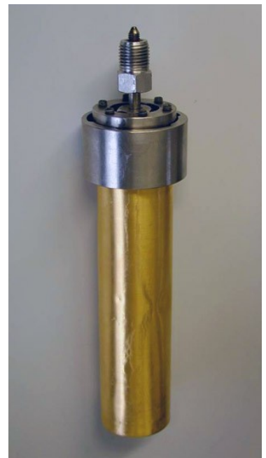
Abbildung 5: Reaktionsgefäß aus Gold und Titan für geochemische Experimente (Länge ca. 15 cm)
