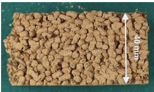
Abbildung 8: Kompositwerkstoff aus extrudierten Biopolymer-Granalien mit Geopolymerbindung (links gebrochene Granalien)
