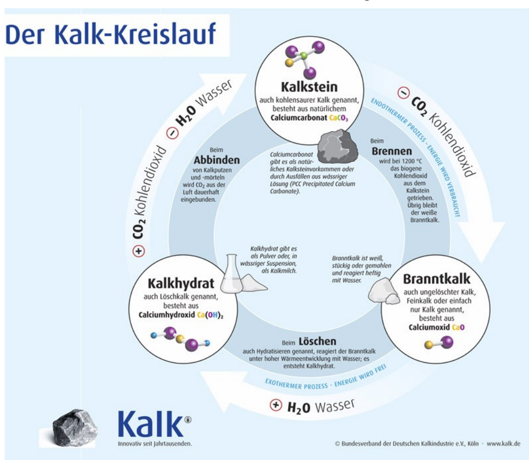
Abbildung 1: Der Kalk-Kreislauf (Quelle: BVK)
