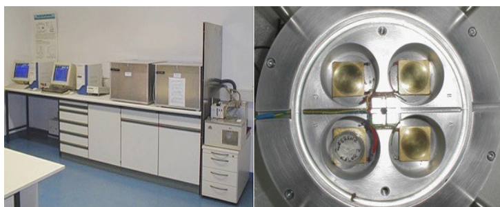
Abbildung 1: links: Klimatisierter Kalorimeterraum mit zwei Kalorimetern rechts: Messstelle mit Referenz und drei Messplätzen
