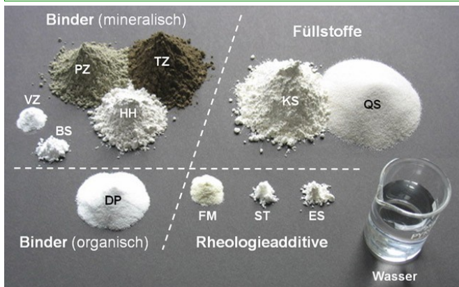
Abbildung 2: Rezepturanteile für eine schnellabbindende selbstverlaufende Bodenspachtelmasse (Abkürzungen: PZ: Portlandzement, TZ: Tonerdeschmelzzement, HH: Halbhydrat von Gips, VZ: Abbindeverzögerer, BS: Erhärtungsbeschleuniger, DP: Dispersionspulver, KS: Kalksteinmehl, QS: Quarzsand, FM: Fließmittel, ST: Stabilisator, ES: Entschäumer.)
